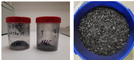
Biochar vyrobený z odpadní biomasy řas a hub; referenční biochar vyrobený z dřevní štěpky
